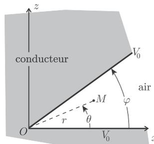
FIGURE 3 – Modèle de coin.
